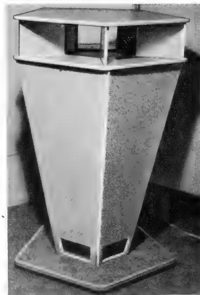
Bild 1. Zusatz-Lautsprecher in einer fünfseitigen Tonsäule
